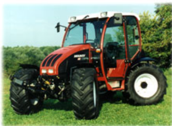
Slika 2.15: Krmiljenje vseh štirih koles REFORM MOUNTY
